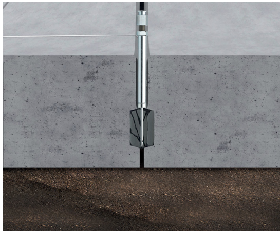
Bild 5: Injektionsbohrnadel in Tübbingfuge
